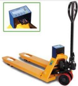
Удобная в обращении и легко управляемая тележка со встроенной системой электронного взвешивания. Весы оснащены четырьмя тензодатчиками «на сдвиг», что гарантирует максимальную точность при взвешивании, и многофункциональным индикатором веса с большим подсвечиваемым дисплеем, который обеспечивает оптимальное считывание в любых условиях освещенности.
